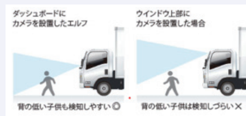
エルフに搭載するステレオカメラによる歩行者の検知
