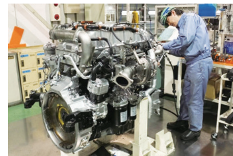
再組み立て中のリビルトエンジン
