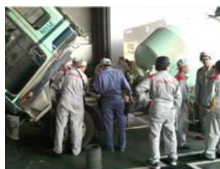
水没したミキサー車の点検
