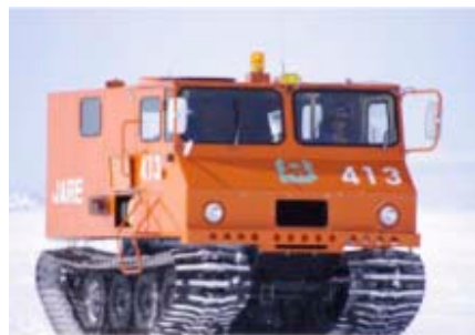
いすゞのエンジンを搭載した雪上車 （株式会社大原鉄工所殿製）
