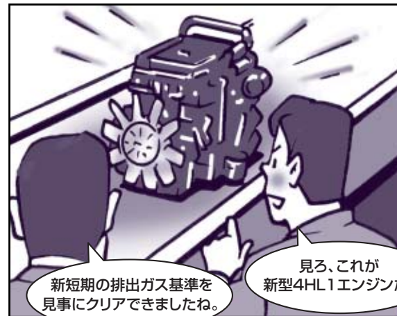
12 新型4HL1エンジンのベンチ試験が続いた。毎日20時間のパターン運転を続け、走行距離に換算すると8.3万kmに及ぶ耐久走行をクリアし、国土交通省が認証する排出ガス基準を達成した。最高にクリーンなディーゼルエンジンがここに誕生した。
