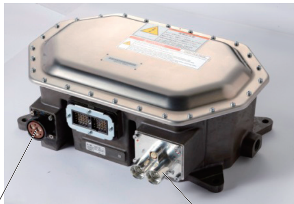
高電圧交流ケーブル接続部
