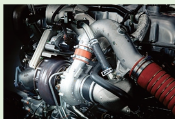
電子制御可変容量ターボ 電子制御化に伴って従来の8段切り換えから無段階に進化し、トルクアップや排出ガスのクリーン化に大きく貢献
