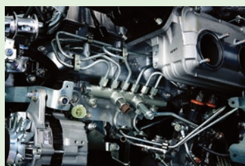
コモンレール式燃料噴射システム 騒音を低減させるプレ噴射、DPDを制御する後噴射など、1行程で最大5回の燃料噴射を行う
