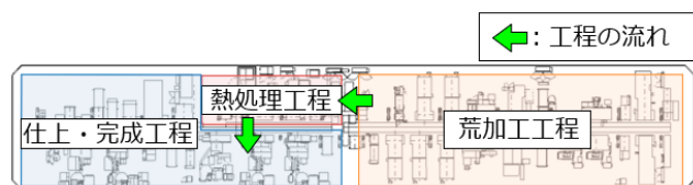
図3 4JZ1カムシャフト機械加工ラインレイアウト図
