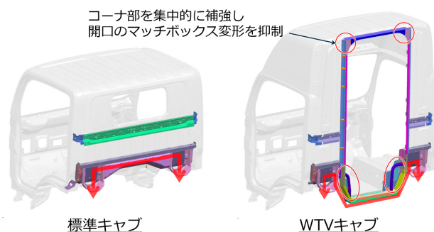
図5 ボディ背面のロードパス比較
