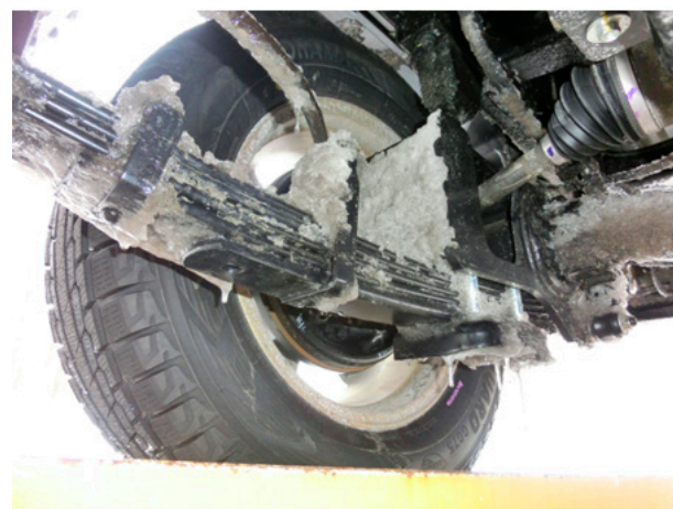
図20 CAE解析結果(上)と実車着雪試験結果(下)の比較
