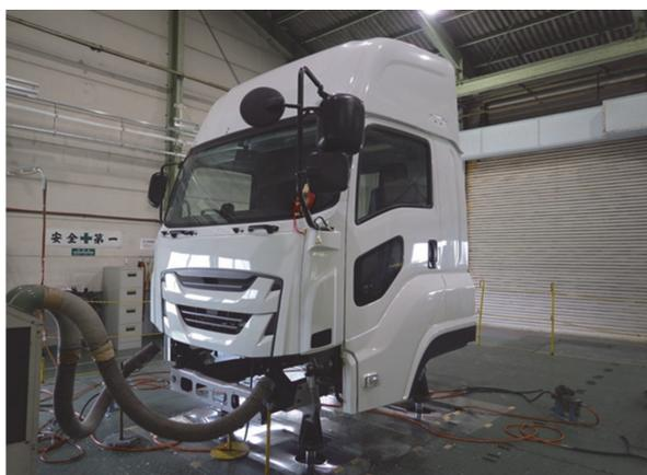
図10 4軸振動試験機
