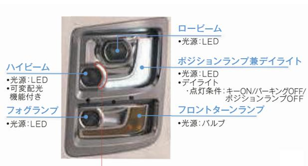
図5 可変配光型ヘッドランプ
