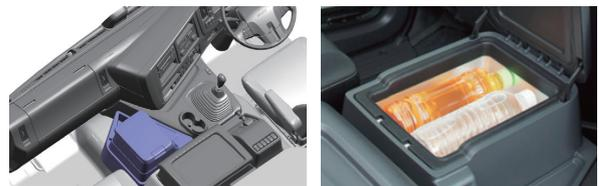
図 12 ホット & クールボックスのレイアウト図
