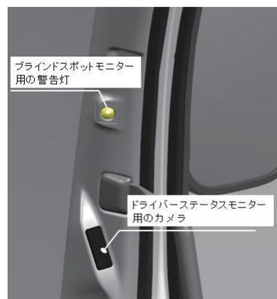
図16 先進安全装置の配置
