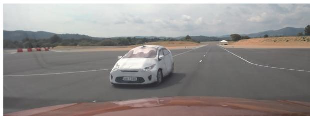
図 5 AEB ターンアシスト試験（左ハンドル車）
