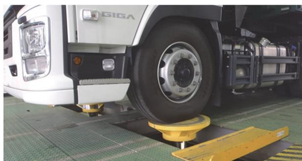
図 9 ロードシミュレータ試験
