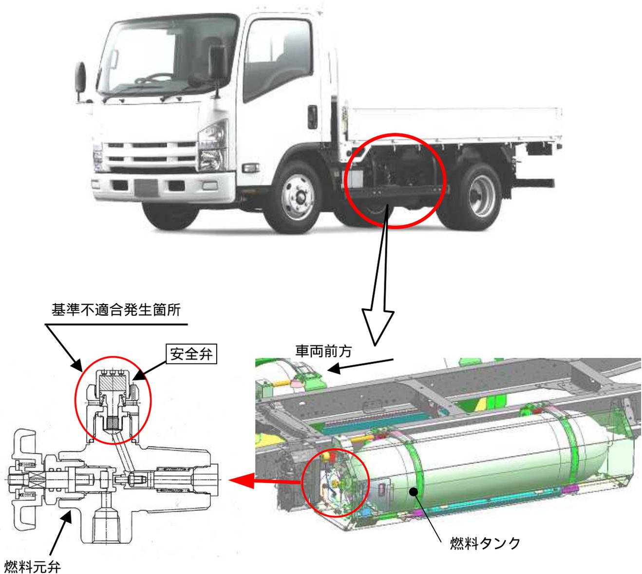
圧縮天然ガス自動車（CNG車）において、燃料タンク安全弁の材質に対して、組立て工場の燃料充填方法が不適切なため、安全弁内部に亀裂が生じる場合がある。そのため、そのままの状態で使用を続けると、亀裂が進行し、燃料が漏れるおそれがある。
