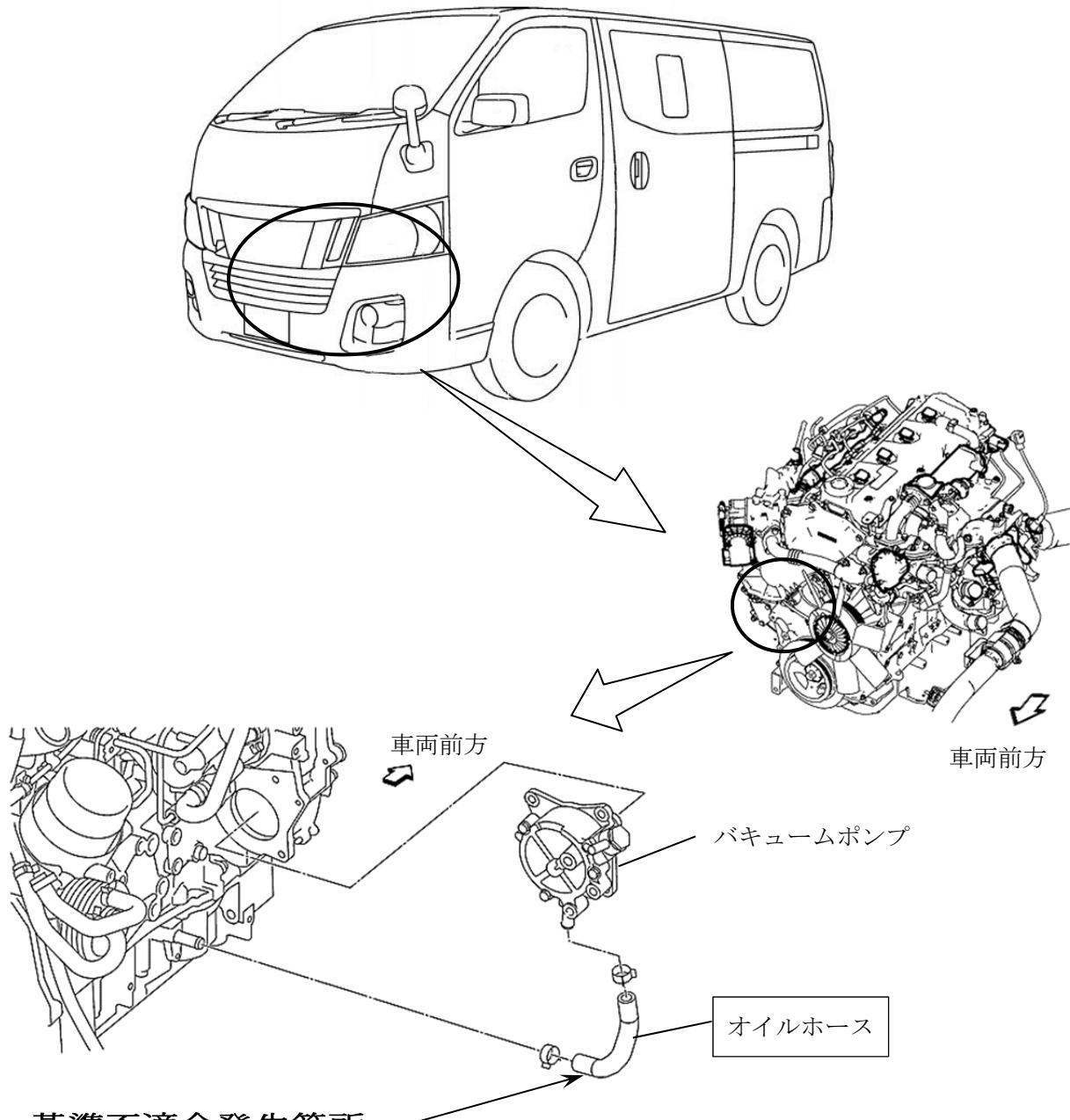
ディーゼルエンジンのバキュームポンプにおいて、オイルホースの耐久性が不足しているため、オイルの圧力変動による変形が繰り返されて当該ホースに亀裂が生じるものがある。そのため、エンジンオイルが漏れて警告灯が点灯し、そのままの状態で使用を続けると、最悪の場合、エンジンが潤滑不良となり、走行中にエンジンが停止するおそれがある。
