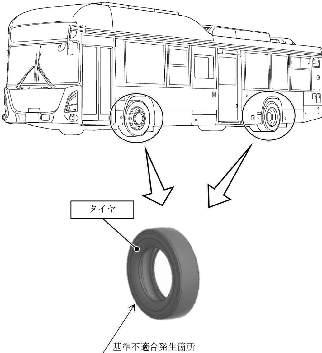
タイヤにおいて、車両製造工場での生産管理が不適切なため、誤品のタイヤが装着されている。そのため、保安基準に適合しない。
