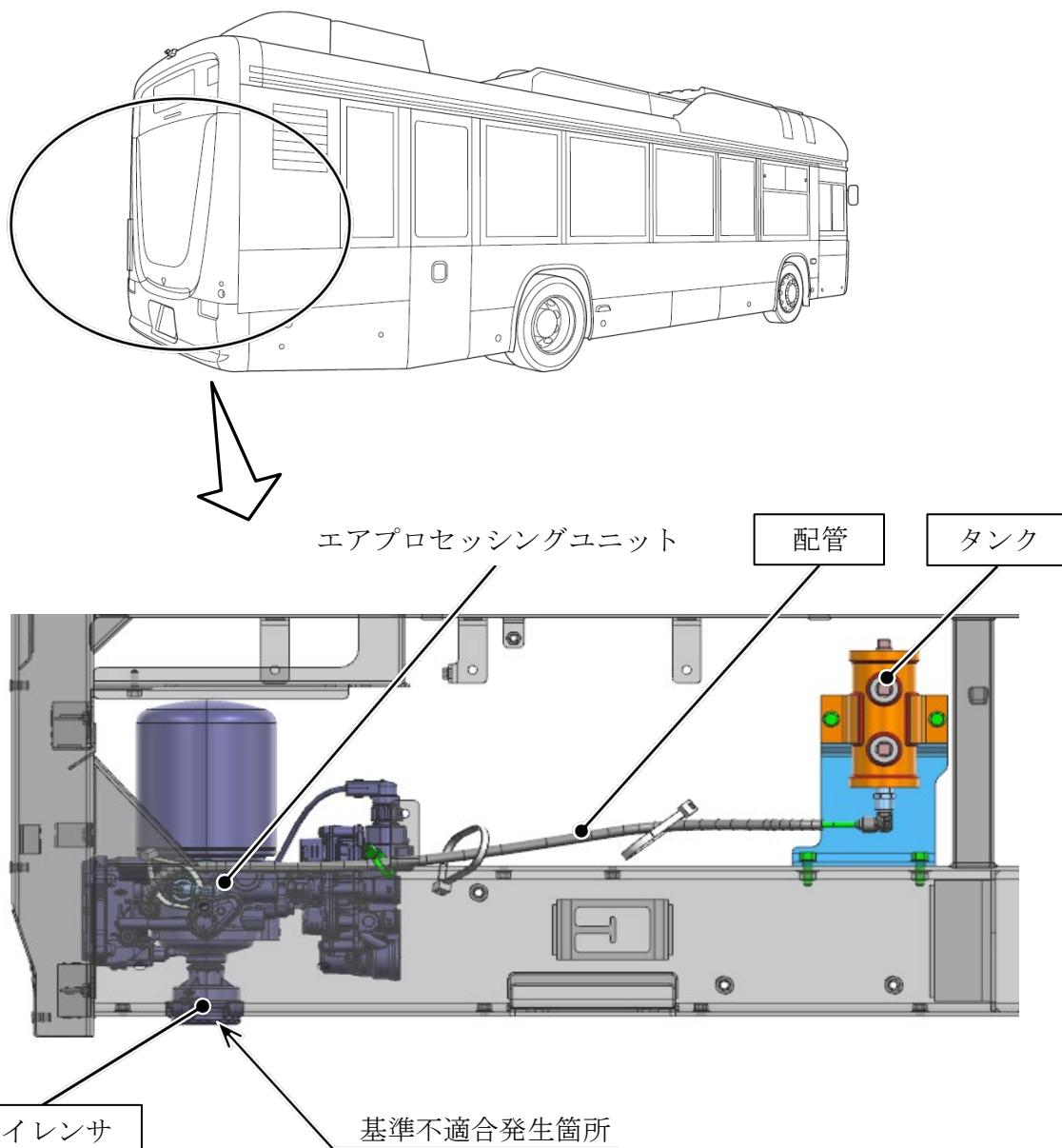
電子制御型エアプロセッシングユニットにおいて、開発時の評価が不適切なため、エアドライヤの圧縮エア排出時にサイレンサが脱落することがある。そのため、他の交通の妨げとなるおそれがあるとともに、圧縮エア排出時の騒音が騒音規制値を超え、保安基準に適合しないおそれがある。
