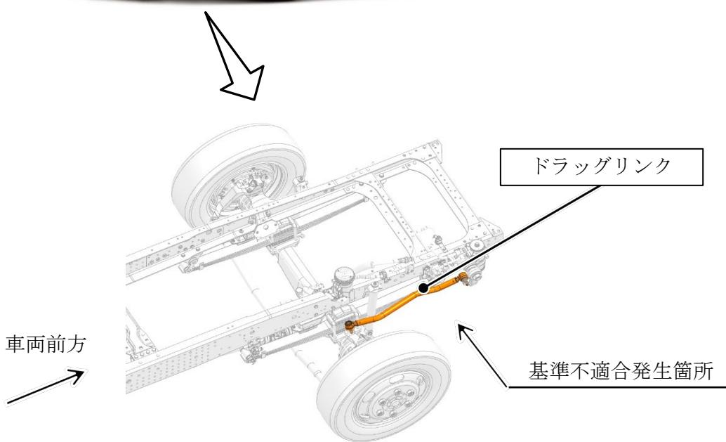
ドラッグリンクにおいて、製造工程での作業指示が不適切なため、フロント側を示すラベルをリヤ側に貼付けたものがある。そのため、ドラッグリンクを車両へ前後逆に組付けことにより、タイヤとの隙間が小さくなり、タイヤチェーン装着時にドラッグリンクとタイヤチェーンが接触するおそれがある。
