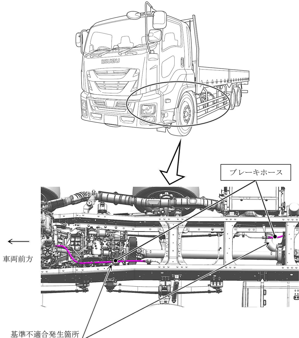
大型トラックのエアブレーキ用ブレーキホースにおいて、ホース製造工程での作業が不適切なため、耐久性が不足しているものがある。そのため、そのまま使用を続けると、当該ホースが破損してエアが漏れ、ブレーキ警告灯が点灯し、制動力が低下するおそれがある。
