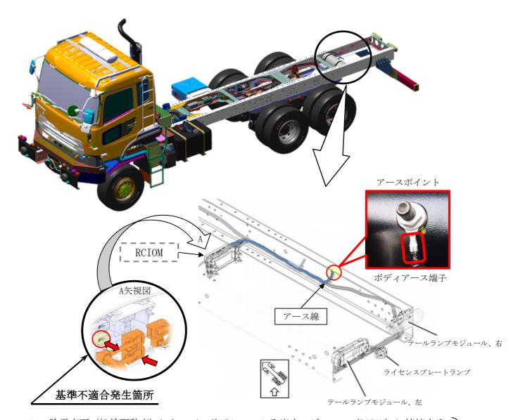
除雪車両(総輪駆動車)において、リアシャーシ入出力モジュール (RCIOM) に接続するハーネスのボディアース端子部の防水処理が不適切なため、雨水または雪解け水等がアース線に浸透しRCIOM接続コネクタ内を腐食させることがある。そのため、導通不良または短絡により運転席のマルチディスプレイモニターに警告メッセージが表示され、テールランプ類が不点灯となるおそれがある。
