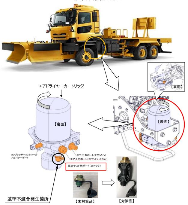
大型トラックのエアドライヤーにおいて、圧縮空気の圧力テスト用コネクタの材質が不適切なため、エアコンプレッサで作られた圧縮空気中に含まれる成分及び高圧力等によって、当該コネクタが腐食割れして圧縮空気漏れを起こすことがある。そのため、亀裂が進行すると圧縮空気の供給量が追い付かなくなるため、エア圧力低下の警告ランプ点灯及び警報が鳴り、最悪の場合、駐車ブレーキが解除できなくなり走行不能に至るおそれがある。
