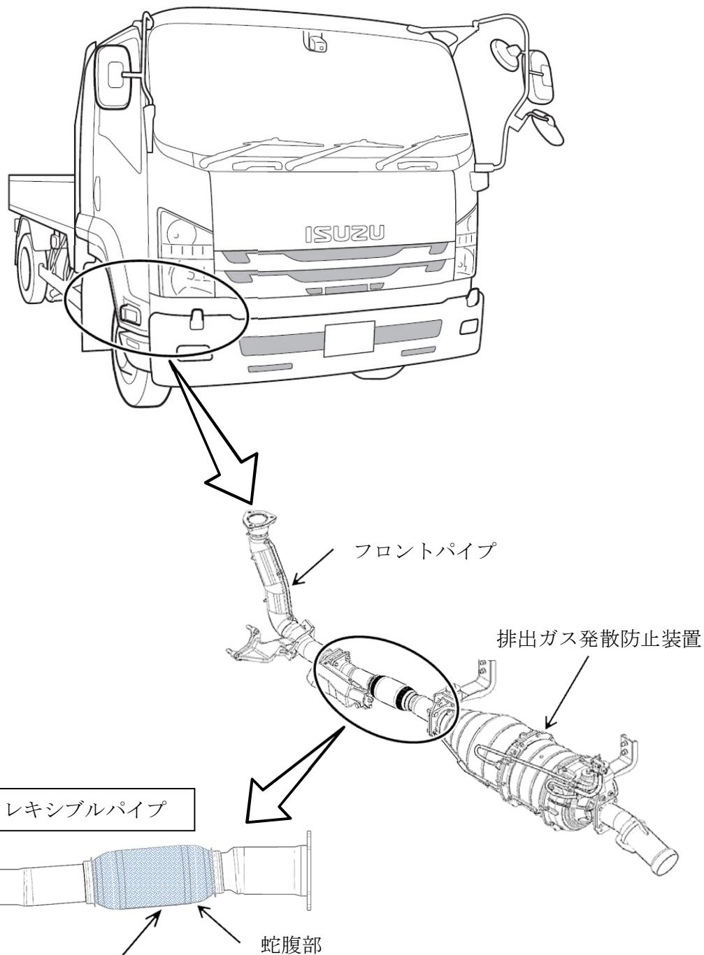
中型トラックの排気管において、フレキシブルパイプ蛇腹部の構造が不適切なため、エンジン回転により当該蛇腹部が共振するものがある。そのため、内部部品が擦れ合い、そのまま使用を続けると、摩耗して穴が開き、排気ガスが漏れるおそれがある。
