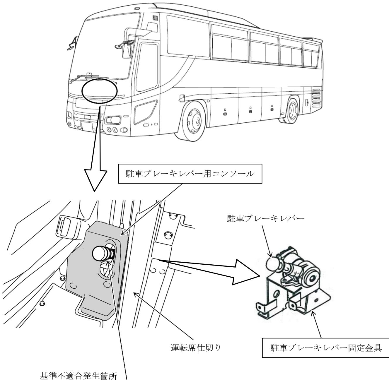
大型バスにおいて、駐車ブレーキレバー用コンソールの固定方法が不適切なため、当該コンソールと運転席仕切りの間に物をはさむと当該コンソールがずれて、駐車ブレーキレバーと干渉することがある。そのため、駐車ブレーキレバーを引き上げるとロック位置の手前で保持され、最悪の場合、エンジンの振動等によりレバーが解除され車両が動き出すおそれがある。
