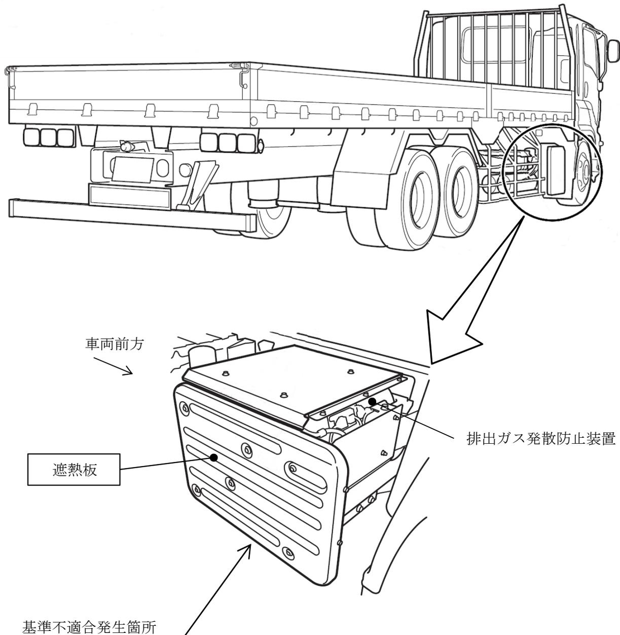
大型トラックにおいて、排出ガス発散防止装置の遮熱板の組み付け工程が不適切なため、誤った仕様の遮熱板を組み付けたものがある。そのため、前輪タイヤの最後部の後端と当該遮熱板の距離が400mmを超え、巻込防止装置に係る保安基準に適合しなくなるおそれがある。
