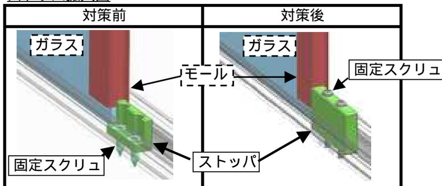
窓ガラスの開口幅を制限するストッパ付きの引き違い窓を装着した路線バスにおいて、ストッパ形状が不適切なため、ガラスモールが破損することがある。そのため、当該窓の開閉操作を強い力で繰り返すと、ガラスがストッパ固定スクリューと接触し、最悪の場合、ガラスが破損するおそれがある。
