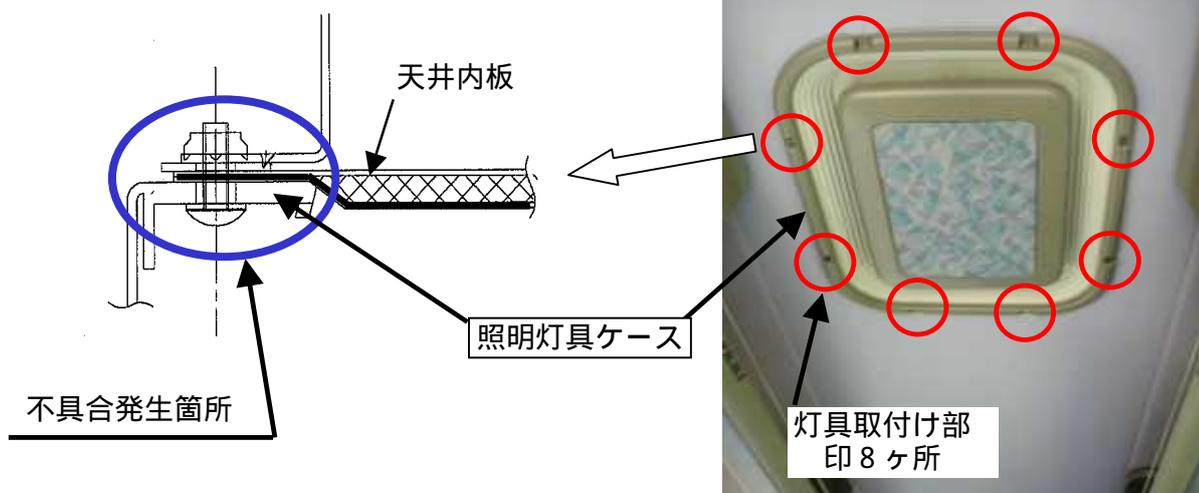
大型観光及び高速路線バスの間接室内照明を装備した車両において、室内照明の灯具ケース材質が不適切なため、当該ケースの取付け部が破損するものがある。そのため、そのままの状態で使用を続けると、室内照明が天井の内張りから外れ、落下するおそれがある。
