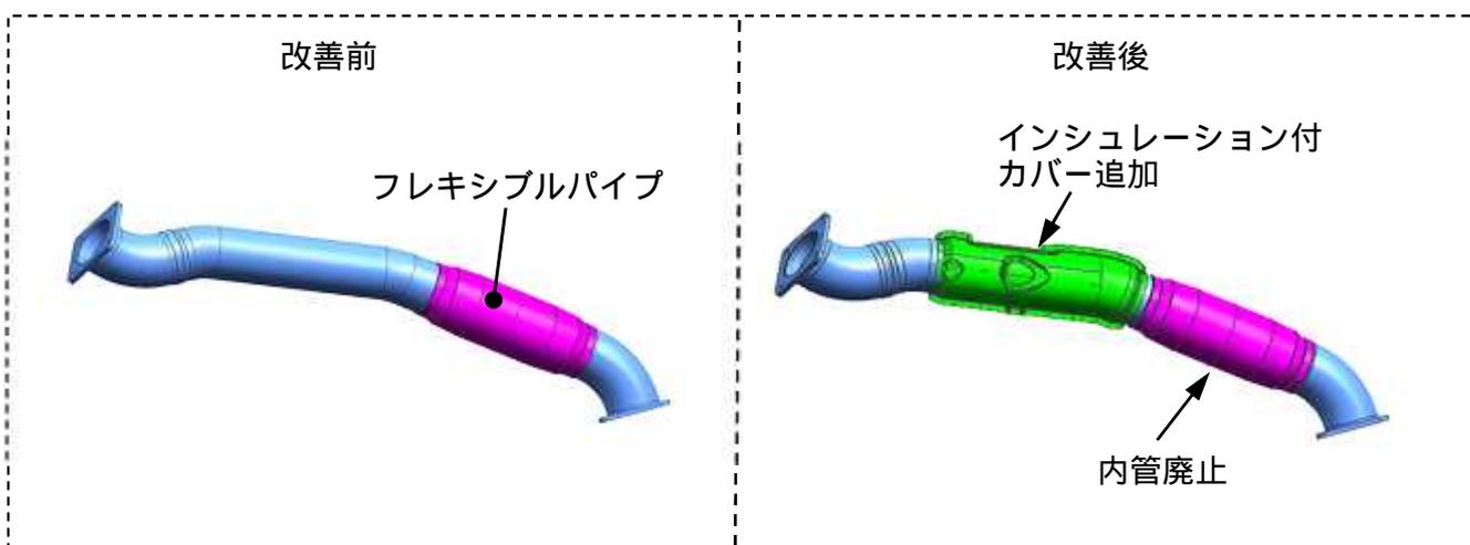
大型トラックにおいて、排気管のフレキシブルパイプの構造が不適切なため、走行時の振動によりフレキシブルパイプのベローズが内管と干渉し、摩耗するものがある。そのため、そのまま使用を続けると摩耗が進行して穴があき、最悪の場合、排気ガスが漏れるおそれがある。
