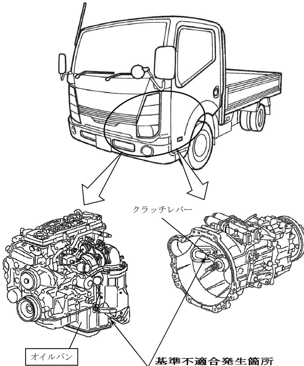
自動6速マニュアルモードトランスミッションにおいて、エンジンのオイルパンの形状が不適切なため、トランスミッションとの連結部から雨水等が浸入するものがあり、クラッチレバーの支点が錆びて固着し、クラッチが切れず、警告灯を点灯するとともに保護制御によりギヤを固定して、変速できなくなるおそれがある。
