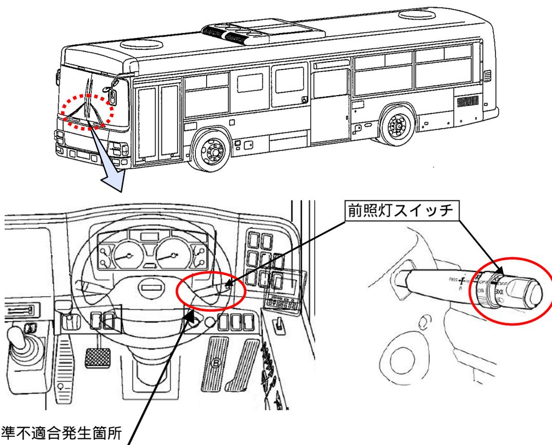
前照灯消し忘れ防止装置を取付けた路線バスにおいて、当該装置の電気回路が不適切なため、前照灯スイッチに想定以上の電流が流れることにより、当該スイッチの接点が摩耗し、そのままの状態で使用を続けると、当該スイッチの接点が折損し、前照灯が点灯しなくなるおそれがある。
