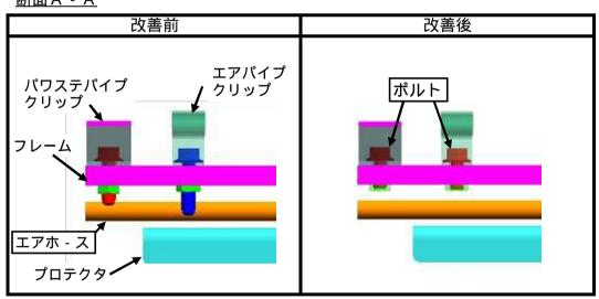
大型トラックのブレーキ用エアホースにおいて、当該ホースの取付け位置が不適切なため、エアパイプクリップ固定ボルトとプロテクタの間に挟まれるものある。そのため、当 該ホースに穴が開き、最悪の場合、制動力が低下するおそれがある。
