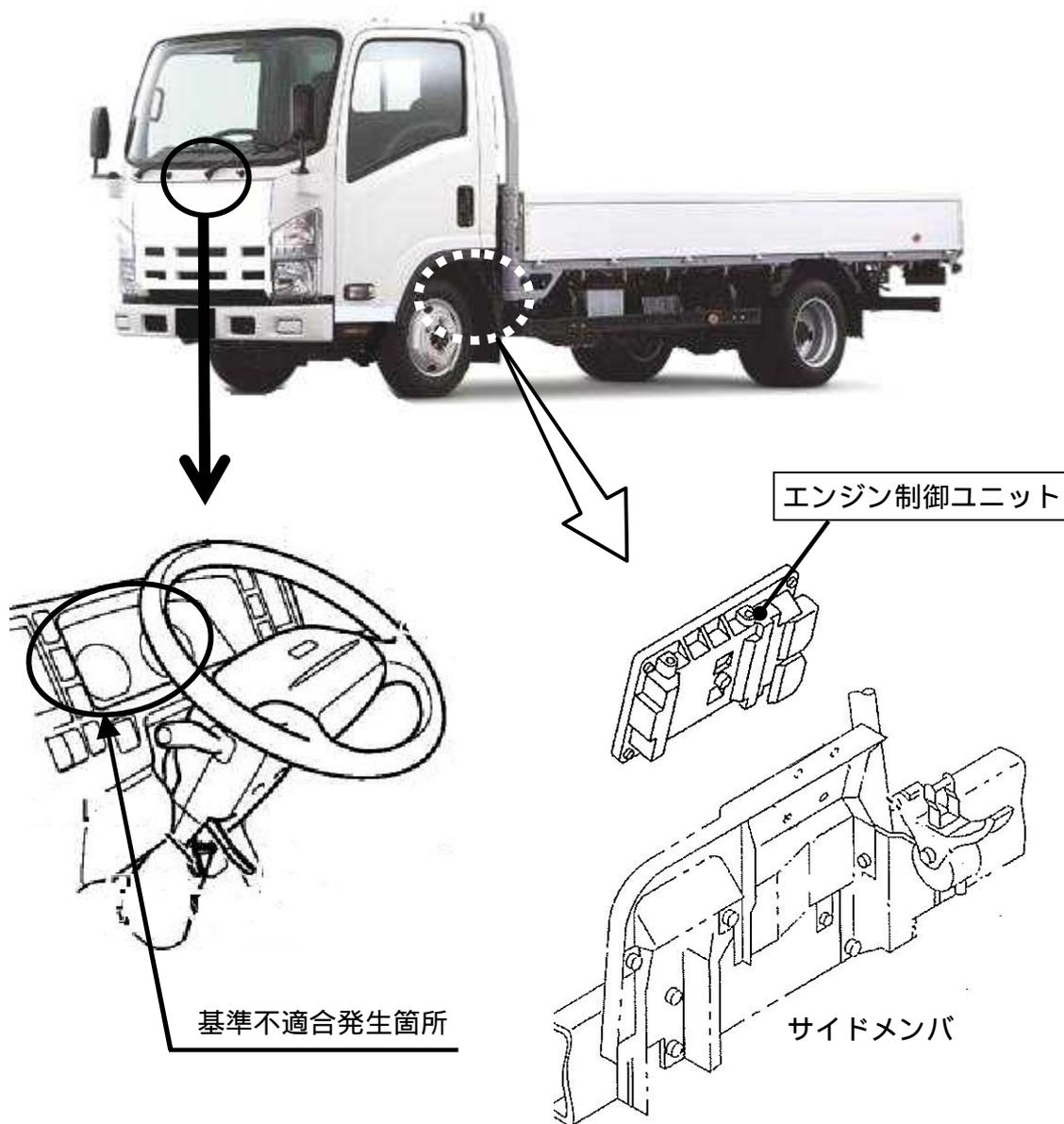
圧縮天然ガス自動車（CNG車）の小型トラックにおいて、エンジン制御ユニット（ECM）の速度演算プログラムが不適切なため、速度計の表示が実際の車体速度より低く表示されるおそれがある。
