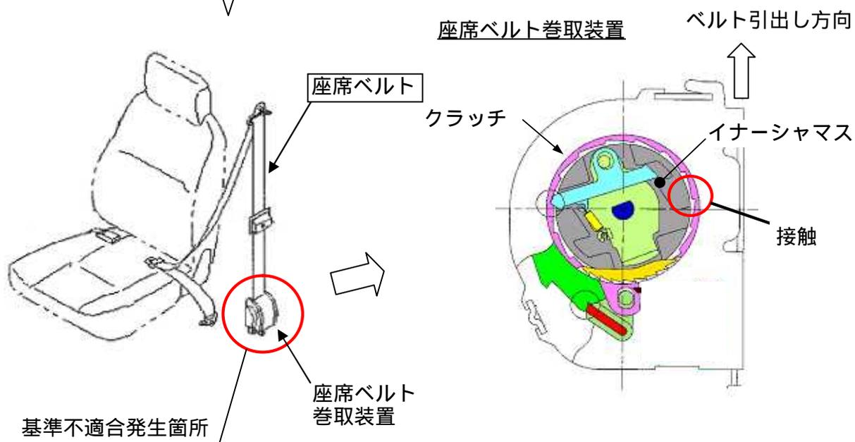
座席ベルト巻取装置の内部部品（イナershアマス）の製造工程において、不適切な材料を使用したため、当該部品が変形し、座席ベルトが引き出せなくなるおそれがある。
