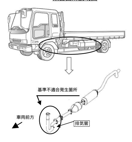
圧縮天然ガス自動車において、排気管の固定方法が不適切なため、共振振動を 起こし、排気管のフランジ部に亀裂が入ることがある。そのため、そのままの状態で使用を続けると、排気管が折損し、騒音が増大するおそれがある。
