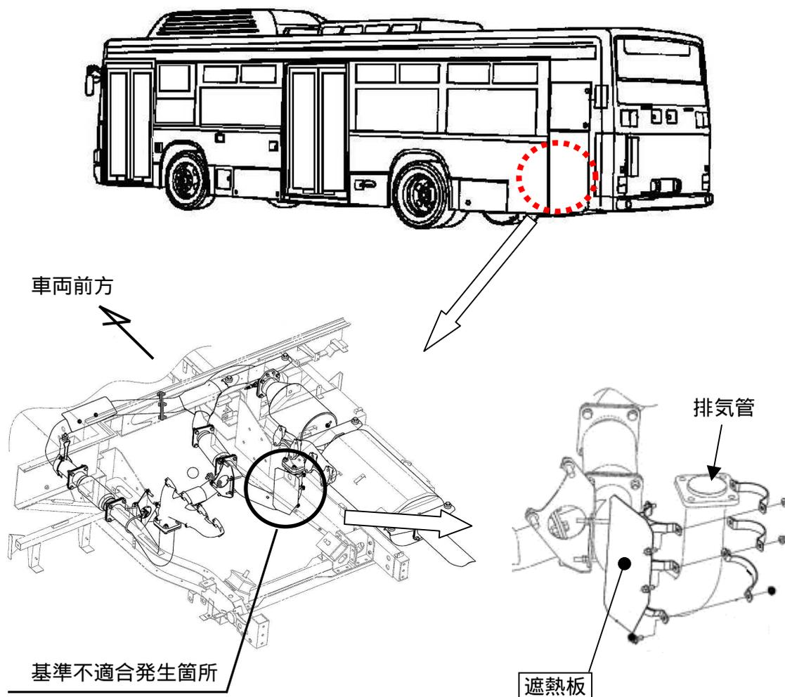
〔 圧縮天然ガス自動車（CNG車）の路線バスにおいて、排気管に取り付けた遮熱板の溶接が不適切なため、排気管の熱及び車両振動により溶接部が破損するものがある。そのため、そのままの状態で使用を続けると、最悪の場合、遮熱板が脱落するおそれがある。 〕
