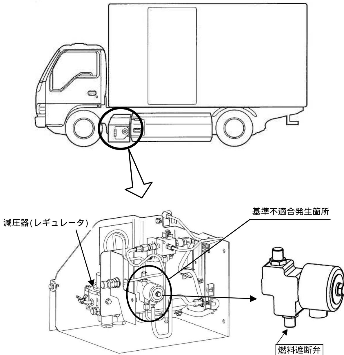
圧縮天然ガス自動車（CNG車）において、燃料の供給を停止する燃料遮断弁の気密性が悪いため、エンジン停止時にガスが漏れるものがある。そのため、そのままの状態で使用を続けると、吸気管から車室内にガスが浸入することから、最悪の場合、車室内で火を使うと引火するおそれがある。
