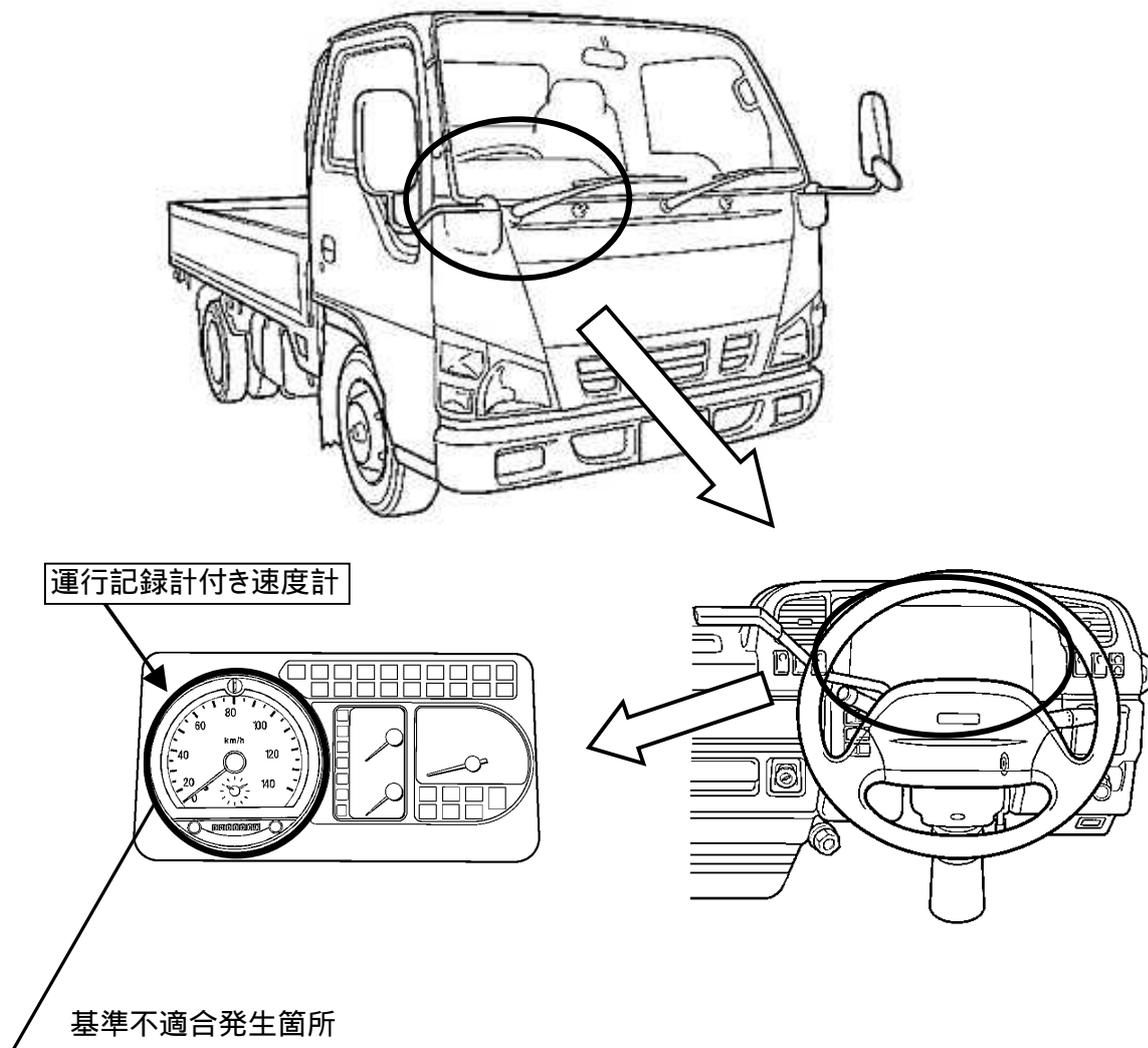
運行記録計付き速度計（タコグラフ）において、販売店のオプション部品表の記載内容が不適切なため、速度計の指示の範囲が車両の性能上の最高速度を表示できない速度計を取り付けた車両がある。
