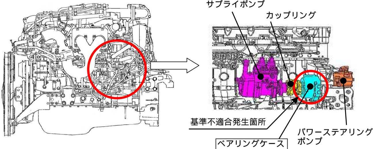
サブライポンプを作動させるギヤ部において、ベアリングの潤滑方法及びベアリングケースの材質が不適切なため、ベアリングが損傷するものがある。そのため、サブライポンプのカップリング及びギヤが破損し、そのままの状態で使用を続けると、最悪の場合、走行不能並びに操舵力の増大に至るおそれがある。
