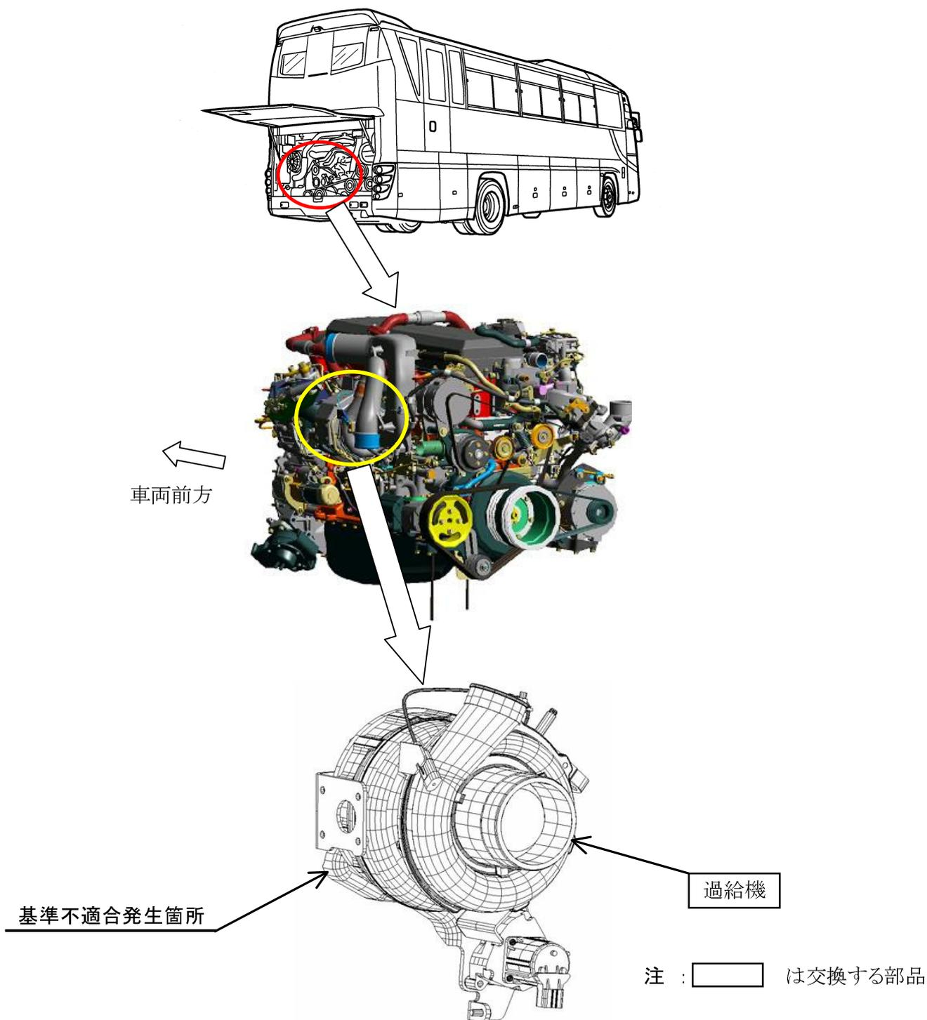
大型観光バスの原動機の変速ノズル付過給機において、タービン翼の強度が不足しているため、高回転域での共振により、タービン翼が破損することがある。そのため、そのまま使用を続けると、白煙の発生及び出力不足になり、運行出来なくなるおそれがある。
