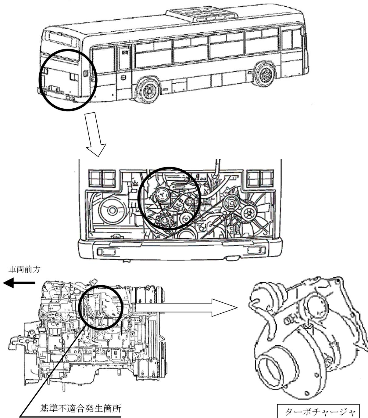
路線バスにおいて、ターボチャージャ回転の変動に対して、ターボコンプレッサ翼車の強度が不足しているため、発進時にエンジンを高回転域まで使った操作を繰り返すと、コンプレッサ翼車が破損することがある。そのため、そのまま使用を続けると、白煙の発生及び出力不足になり、運行出来なくなるおそれがある。
