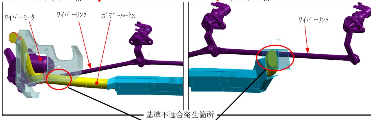
【 インストルメントパネル内のハーネスとワイパーリンクの隙間が不足しているものがあるため、ワイパー作動時にワイパーリンクが当該ハーネスに接触する可能性がある。そのため、当該ハーネスが損傷して、最悪の場合、エアバッグの誤展開やエンジンの停止などが発生するおそれがある。 】
