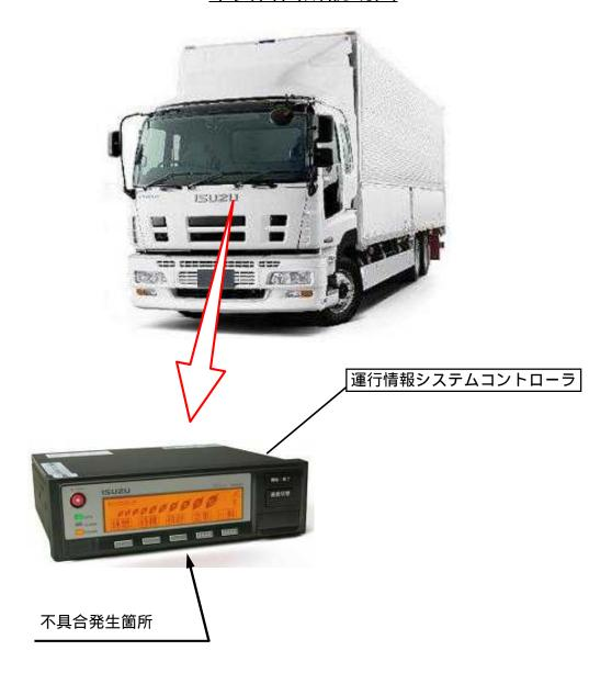
後付け部品として販売した運行情報システムを搭載している車両において、当該システムのコントローラの制御プログラムが不適切なため、運行情報を処理する複数の作業が重なった場合、車速データの記録プログラムが停止することがある。そのため、当該システムに内蔵されているデジタル式運行記録計へ、車速データが記録できなくなるおそれがある。
