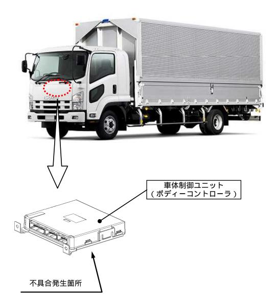
後付け部品として販売した運行情報システムを搭載している車両において、車体制御ユニット(ボディーコントローラ)のプログラムが不適切なため、エンジンを停止した際に、運行情報システムの影響により、車体制御ユニットの内部データを書き換えてしまうことがある。そのため、当該ユニットが制御しているハザードランプ、エアコンファン等が誤作動するおそれがある。
