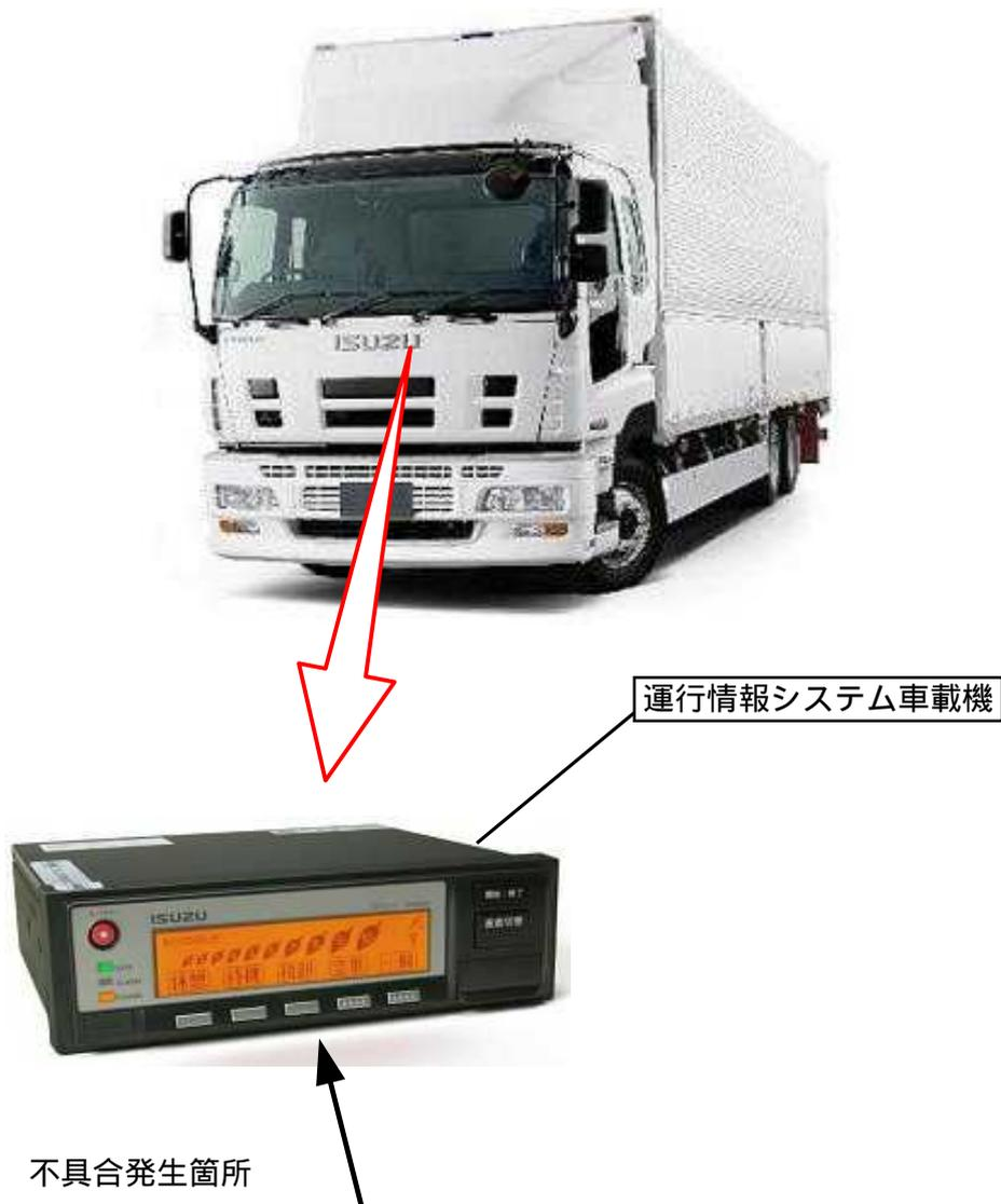
後付け部品として販売した、デジタル式運行記録計（自TD - 6）付き運行情報システムを搭載している車両において、当該システムの車載機のプログラムが不適切なため、データ処理量が過多となった場合、プログラムが停止することがある。そのため、運行記録計への信号送付が停止し、データの記録ができなくなるおそれがある。
