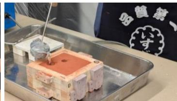
木枠に砂を詰めて鑄型を作り、溶かした錫を流して鑄物を作ります
