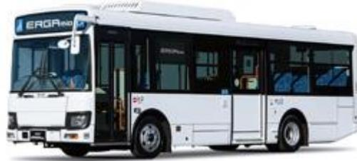
新型「エルガミオ」では、ノンステップエリアの通路幅・室内高、および後方段上部の室内長・室内高を拡大し、広々とした室内空間を実現することで、利便性・安全性を更に向上しました。また、優先席まわりの安全性向上、反転式スロープ板の採用による車いす乗降の簡易化・時間短縮化を図りました。さらに、新たな車いす固定装置により作業の省力化が可能になるなど、バリアフリー・ユニバーサルデザインをレベルアップした車両となっています。
