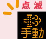
手動再生せずに走り続け、「すす」がたまりすぎると、エンジンのチェックランプが点灯し出力制限がかかってしまいます
