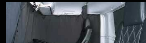
ラウンドカーテン (レール&玉付、生地付) *写真は標準ルーフ
