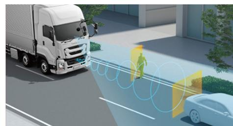
プリクラッシュブレーキ（衝突回避支援／衝突被害軽減）：走行中、ミリ波レーダーとカメラが常に車両前方を検知・分析。先行車／歩行者との車間距離に応じて、警報やブレーキ制御を行う。低速で走行する先行車／歩行者に対し、衝突の恐れが高まると、警報に加え、早いタイミングでフル制動し、衝突回避をサポート。
