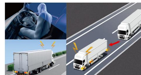
ドライバー異常時対応システム（EDSS：Emergency Driving Stop System）：ドライバーに急病などの異常が発生した場合、EDSSスイッチ操作またはドライバーステータスマニトラー（DSM）による異常検知により、車両が自動で制動をかけ停止するシステム。
