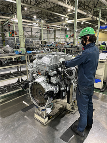
再組み立て中のリビルトエンジン
