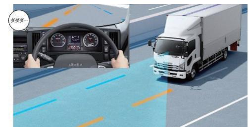
車線逸脱警報（LDWS）：常に走行車線をカメラが監視し、車線の逸脱を検知すると左右それぞれのスピーカーからの警報音とマルチインフォメーションディスプレイの警告表示でドライバーに注意を促す
