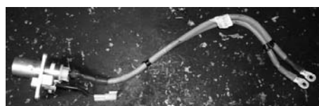
高電圧 DC ケーブル
