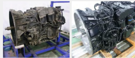
トランスミッション(左: Before、右: After)
