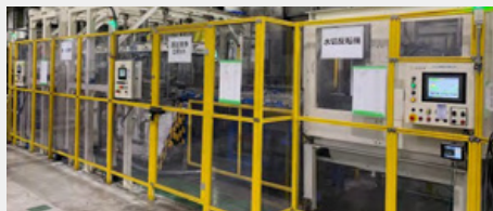
部品の洗浄工程を自動化することで、作業効率化を図っています。
