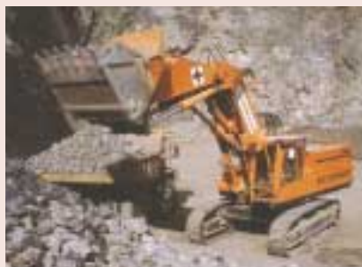
6RB1-Tエンジンを搭載した油圧ショベル
