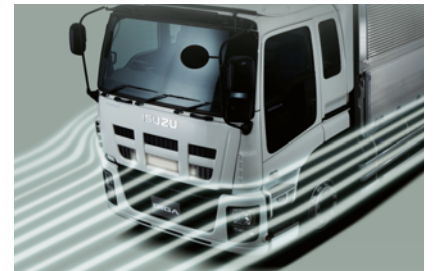
●空気抵抗の低減と冷却性能の向上を狙った新しいキャブフェイス
